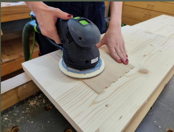
8. Seitenteile maschinell schleifen
