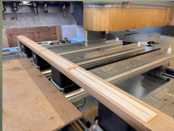
6. Fertig gefräste Rückwände (Aufgehung)
